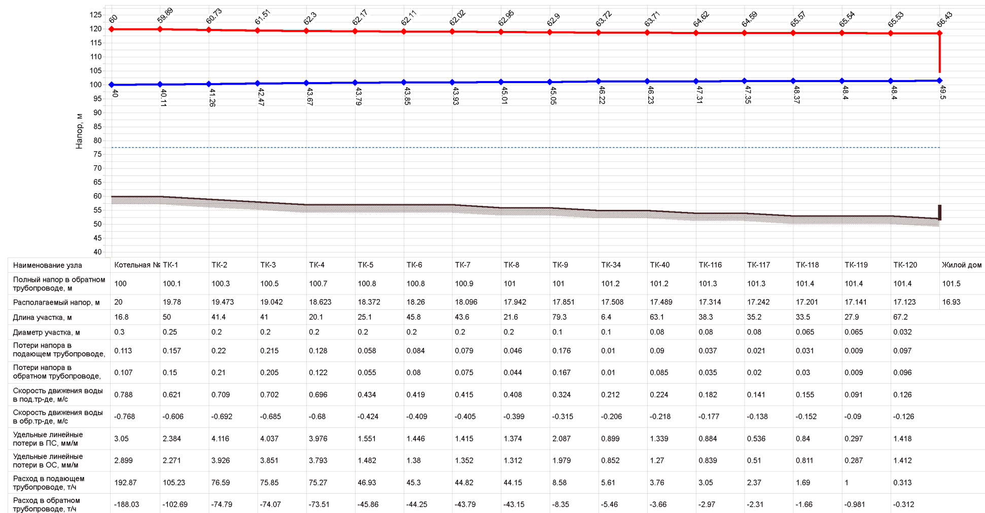
Рисунок 9.37 – Пьезометрический график от котельной №1 до ул. Сосновая, 47а (перспективное положение)
