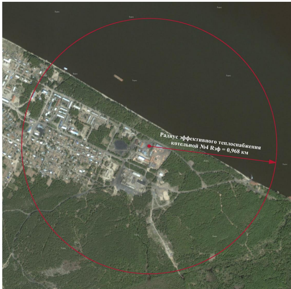
Рисунок 1.4 – Радиус эффективного теплоснабжения котельной №4
