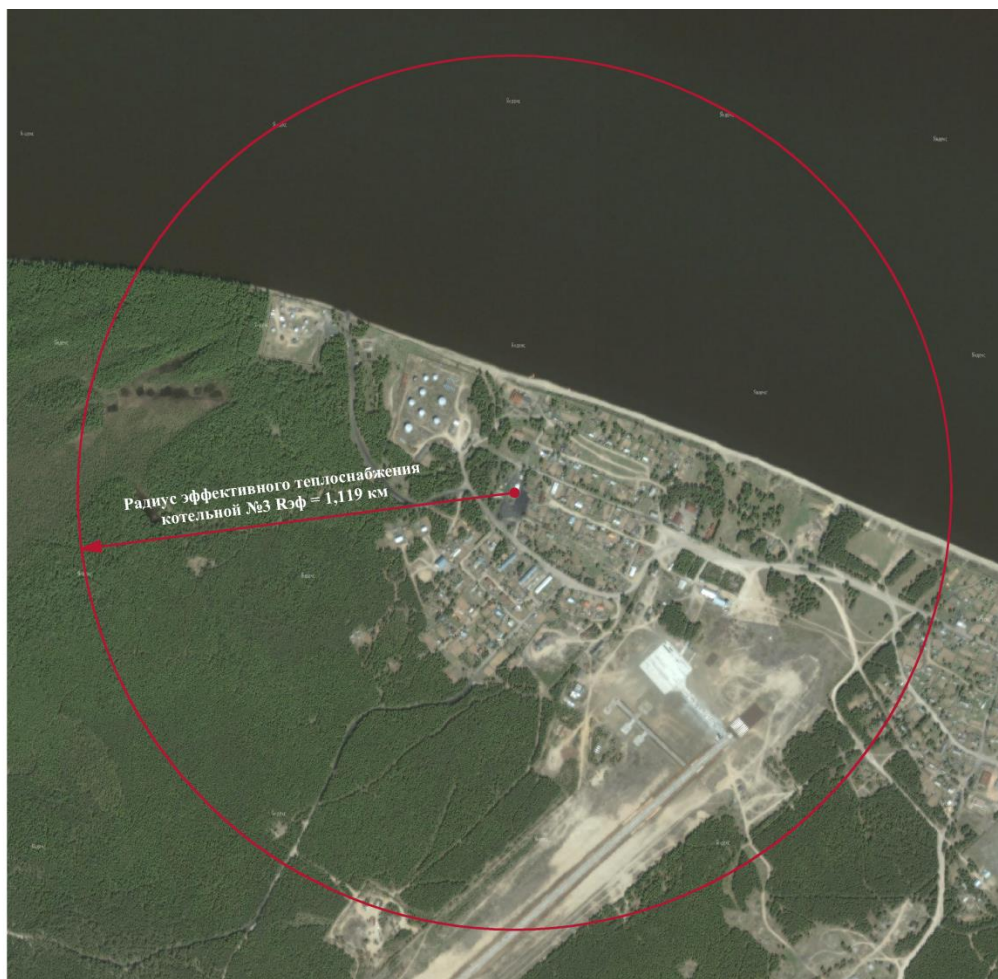
Рисунок 1.3 – Радиус эффективного теплоснабжения котельной №3
