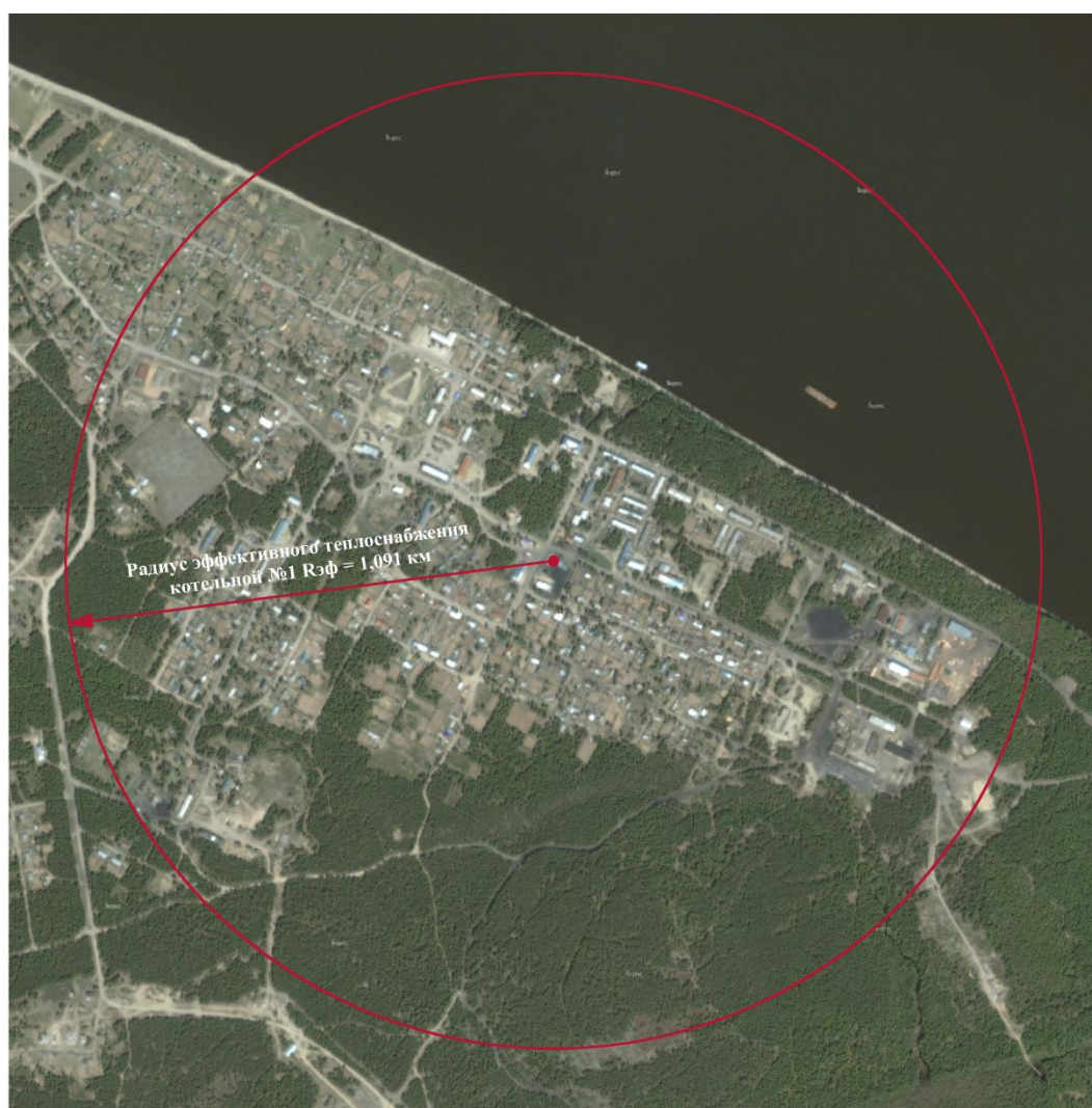
Рисунок 1.1 – Радиус эффективного теплоснабжения котельной №1
