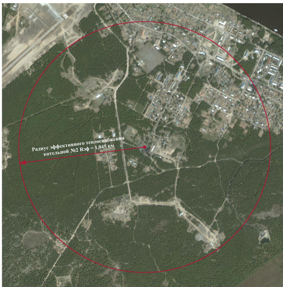
Рисунок 1.2 – Радиус эффективного теплоснабжения котельной №2
